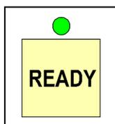
Кнопка для пуска электрошкафа при включении станка, принудительного смазывания и после нажатия кнопки аварийной остановки, этой кнопкой **“READY”** восстанавливается нормальная работа станка.
