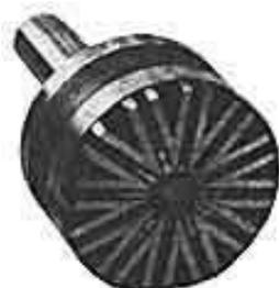
Патрон предназначен для закрепления плоских деталей типа дисков, колец, и т.д. при чистовых и получистовых операциях.
