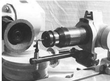
Приспособление предназначено для заточки задних поверхностей винтовых зубьев, расположенных на цилиндре и конусе.
