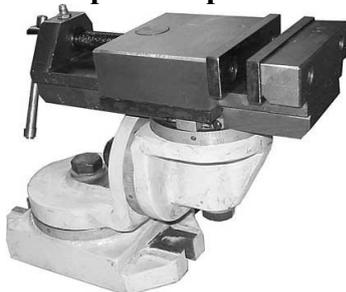
Тиски предназначены для выполнения плоскошлифовальных работ и заточки резцов и плоских протяжек для наружного протягивания.
