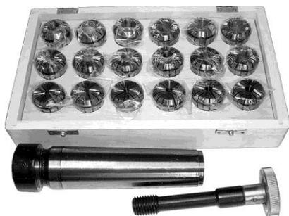
Приспособление предназначено для зажима в универсальной бабке ВЗ-318.П1 концевых инструментов с цилиндрическим хвостовиком. Широкодиапазонные цанги ( $\varnothing 2 \div 20$  мм через 1 мм. 18 шт.)
