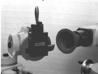
Тиски служат для закрепления резцов и другого инструмента сложной формы при выполнении заточных и шлифовальных работ (используются совместно с приспособлениями ЗЕ642Е.П1 или ВЗ-318.П1)
