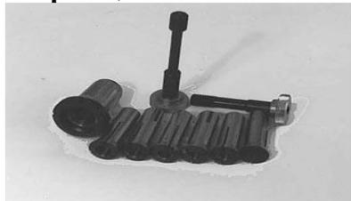
Приспособление предназначено для зажима в универсальной бабке ВЗ-318.П1 концевых инструментов с цилиндрическим хвостовиком.
