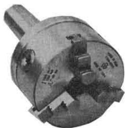
Патрон обеспечивает выполнение различного рода шлифовальных работ при установке концевой инструмента с цилиндрической хвостовой частью.
