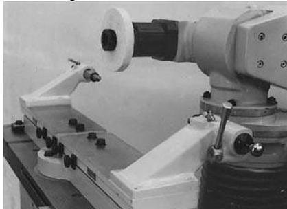
Бабка задняя и передняя предназначены для поддержания длинного центрового инструмента или насадного инструмента на длинной оправке и служат для увеличения межцентрового расстояния.
