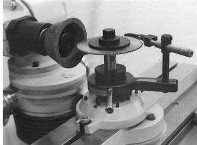
Приспособление предназначено для заточки фрез по ГОСТ 2679-73 по передней и задней поверхности.
