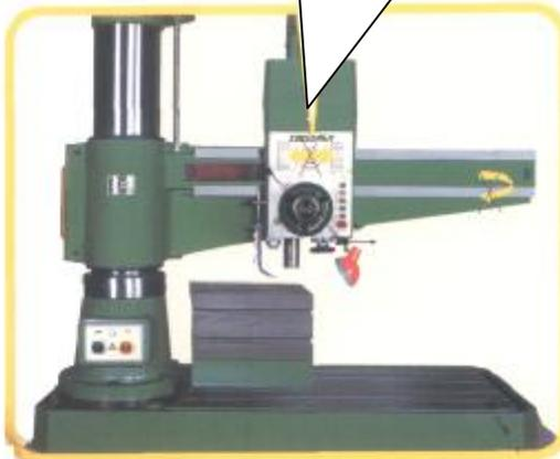
5. При строповке станка необходимо установить на место все части станка и проложить мягкую прокладку между станком и стропами (тросом).
