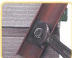
3. Удалите гайку, соединяющую основание станка со столом, поверните стол на 90° и переместите его в положение балансировки центра тяжести.
