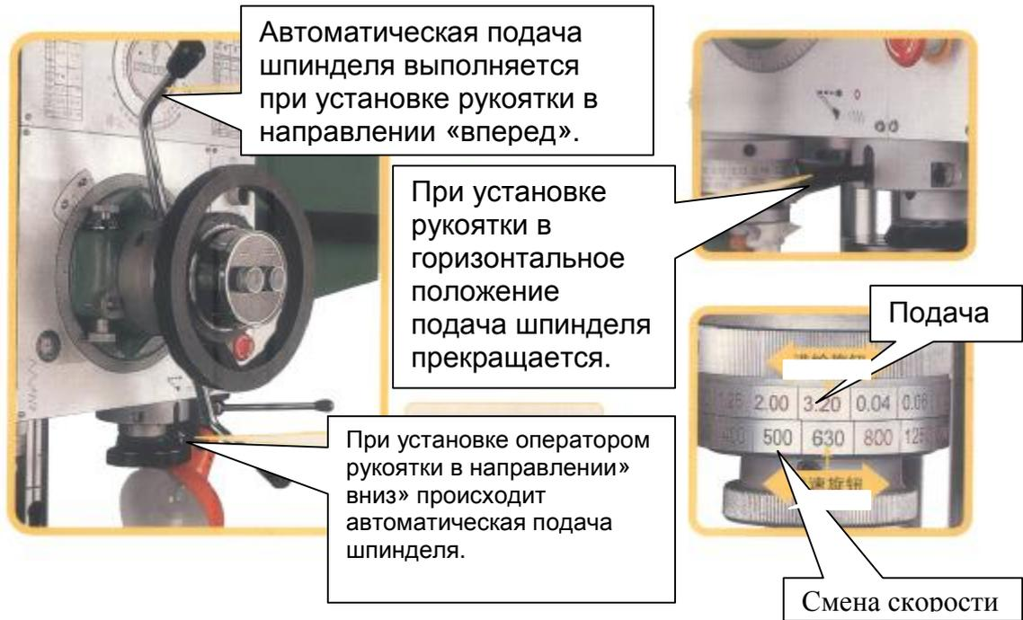
Рис 6 Установка ограничений перемещения пиноли шпинделя
