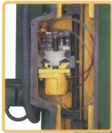
3. Перед тем, как приступить к работе, удалите стопорную планку, расположенную в задней части консоли.
